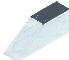
Werkseitiges Schneiden von Böschungswinkeln
